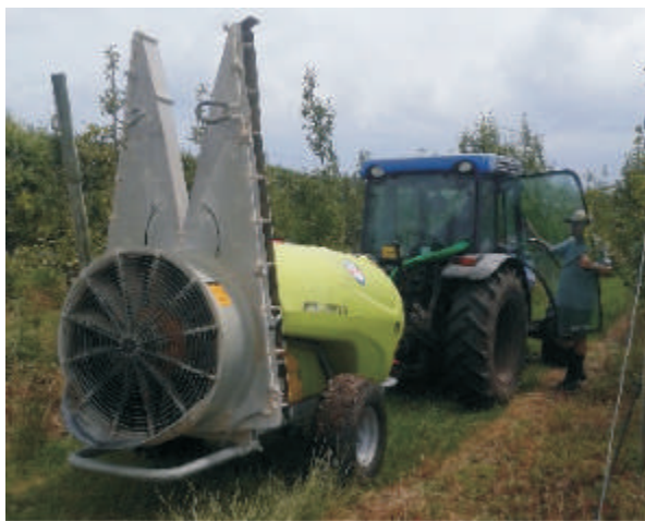
Figura 3: pulverizador de flujo tangencial o torre (B)
