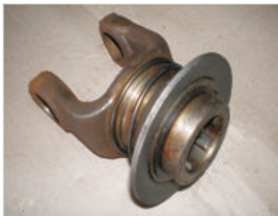
Figura 22: ejemplo de estrías con collar. (Foto cortesía Visca srl).
