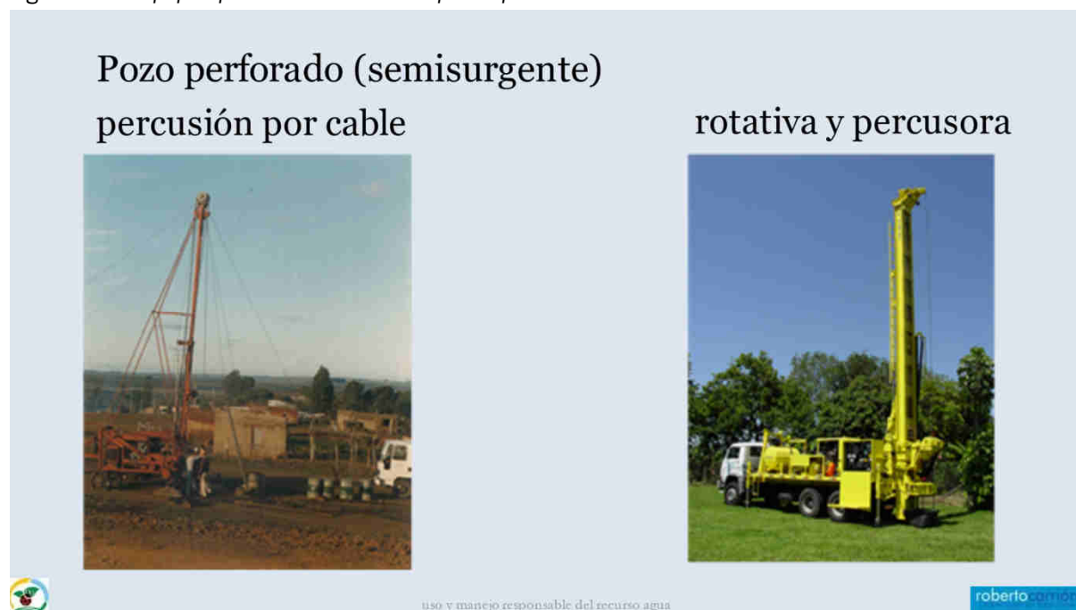
Figura 11 – Equipos para construcción de pozos perforados.
