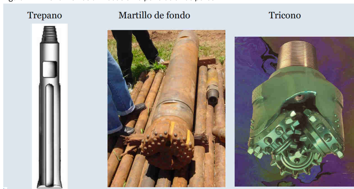
Figura 12 – Herramientas utilizadas en la perforación de pozos.
